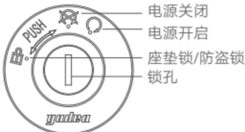
1. 电源开启：钥匙插入电门锁开关，向右顺时针旋转至 位置，接通电源，钥匙不能被拔出。
