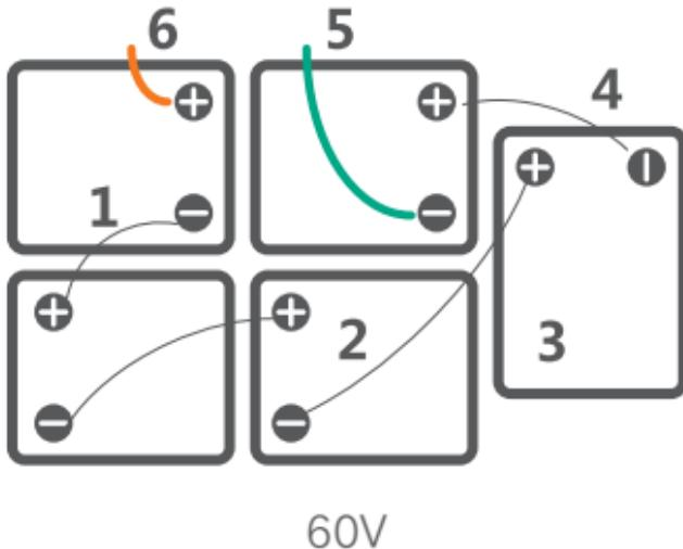
注：首先将6号线（电缆电池正极线）与单个蓄电池正极端连接，其次用电池连接线（按左图所示）将电池组串联起来，最后将5号线（电缆电池负极线）与蓄电池负极相连（仅供参考）。
