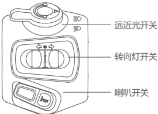
1. 转向灯开关：向左或向右推动开关手柄，可打开对应位置转向灯，发出持续闪烁的橙色灯光信号。同时，仪表盘发出绿色转向指示信号。开关手柄推到中间位置后，即可关闭转向灯。
